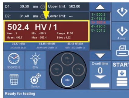
Misurazione fuori dai limiti di tolleranza
